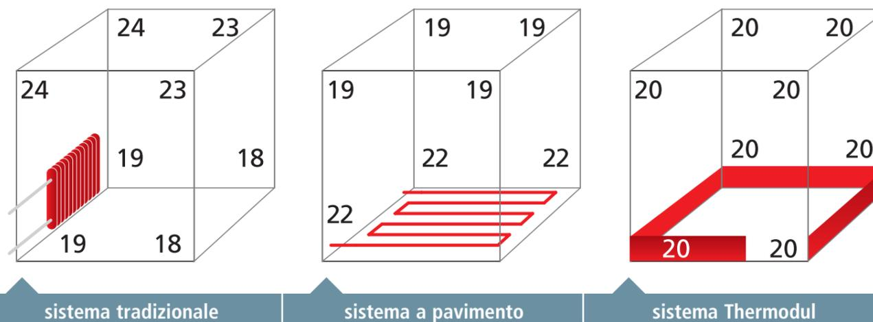
dagli schemi di raffronto si nota che la distribuzione del calore con il sistema di riscaldamento a battiscopa è omogenea da pavimento a soffitto.
